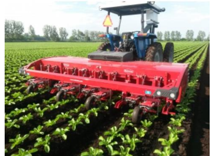
Exemple : désherbeur automatisé (Source : Steketee)
