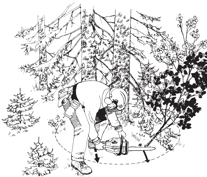
Dégagement du pied de l'arbre
