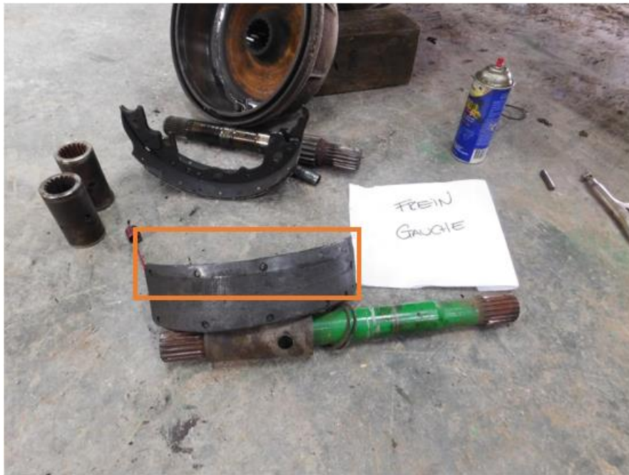
Photo 8 : Mâchoire de frein gauche usée et déformée. (Source : CNESST, 24 septembre 2019)
