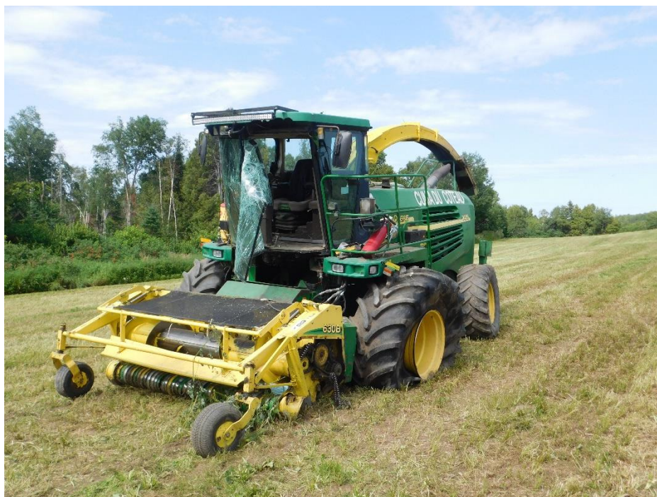
Photo 1 : Récolteuse-hacheuse automotrice (John Deere, 7400) déplacée dans un champ après l'accident. (Source : CNESST, 25 juillet 2019)
