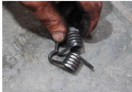
Photo 6 : Ressorts qui ont été usés par frottement à l'intérieur du tambour de frein gauche. (Source : CNESST, 24 septembre 2019)
