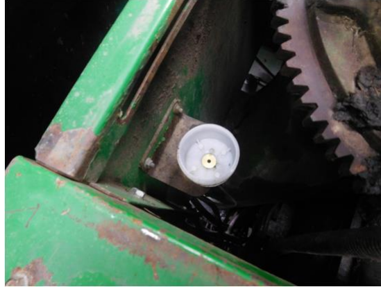
Photo 5 : Réservoir de liquide à frein vide. (Source : CNESST, 24 septembre 2019)
