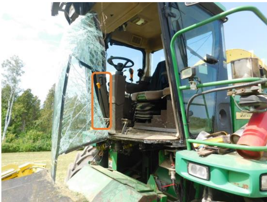
Photo 9 : Position du levier de vitesse lors de l'accident. (Source : CNESST, 25 juillet 2019)
