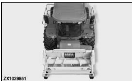
Figure 16 : Ramasseur pour récolteuse de fourrage automotrice (pickup) de marque John Deere, modèle 630B. (Source : Livret d'entretien. Page 60-1)
