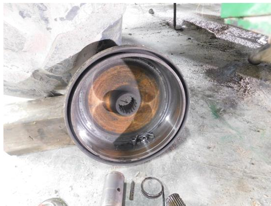
Photo 7 : Tambour gauche usé par le frottement des ressorts. (Source : CNESST, 24 septembre 2019)
