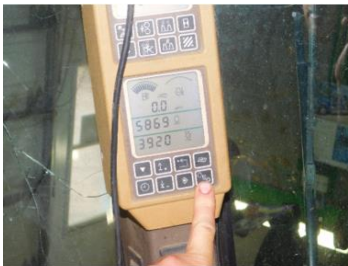
Photo 4 : Valeurs indiquées sur le contrôleur multifonction lorsque la touche « heure de service du moteur et du rotor multicouteau » est pressée. (Source : CNESST, 24 septembre 2019)
