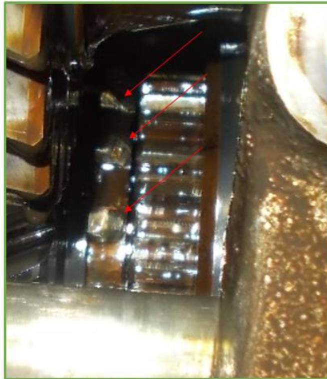
Photo 10 : Usure du manchon au niveau de la 2 e vitesse dans la boîte de transmission. (Source : CNESST, 24 septembre 2019)
