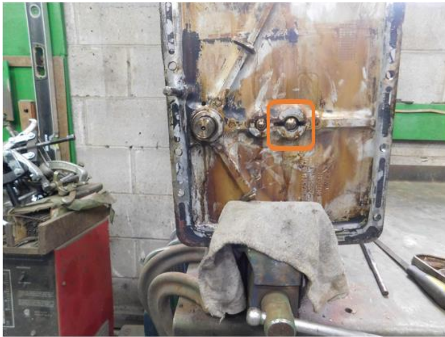
Photo 11 : Bille coincée dans le couvercle du carter de transmission. (Source : CNESST, 24 septembre 2019)
